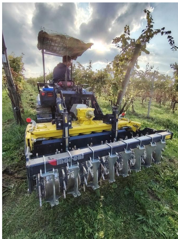
Fig. 10 – Fotografie scattate durante la giornata formativa, in cui sono visibili a destra il macchinario impiegato per le lavorazioni dell'interfilare a file alterne (erpice per lavorazioni su sodo) e il risultato della lavorazione superficiale sul cotico erboso.
